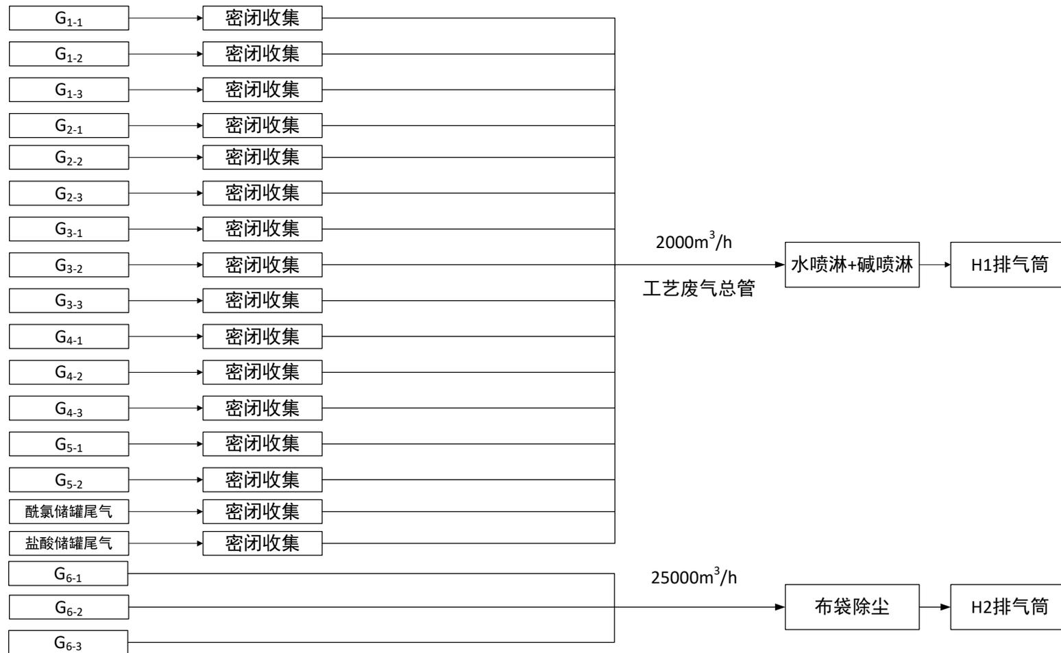
图 4.2.10.1-1 技改项目有组织废气走向图
