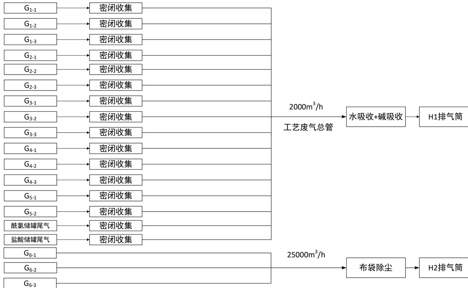
图 7.1.1-1 技改项目有组织废气收集、处理走向图
